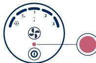
フィルター交換お知らせランプが赤く点灯したら、メインフィルターを交換してください。使用状況や空気質の状態によって異なりますが、使用開始から約6カ月～9カ月の間に交換することを推奨します。
